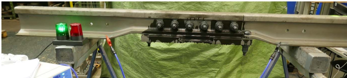
Abbildung 9: Messung des Isolationswiderstandes zwischen den Schienenprofilen
