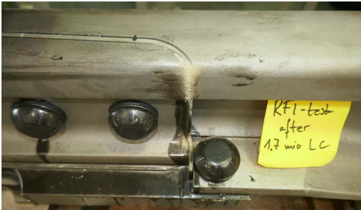
Abbildung 7: Ansicht der Stoßfuge nach 1,7 Millionen Lastspielen
