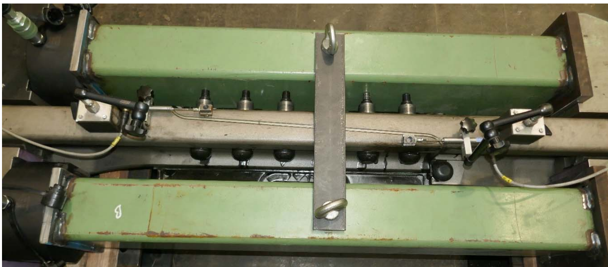
Abbildung 5: Probe ABJ-007 im Prüfaufbau zum Nachweis der Längskraftabtragung
